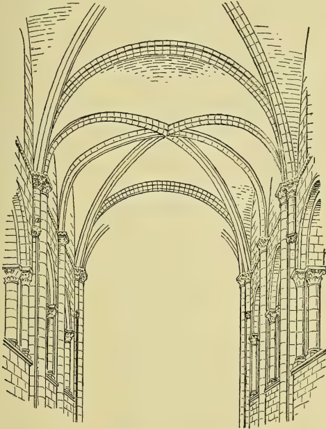
FIG. 15.—System of the Abbaye-aux-Hommes.
